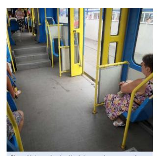
Figura 53: La modernización de los tranvías es a menudo una alternativa rentable a la adquisición de nuevos vehículos. La figura muestra un tranvía renovado con acceso a nivel que funciona en un sistema de tranvías de Kiev. ©Mathias Merforth 2012
