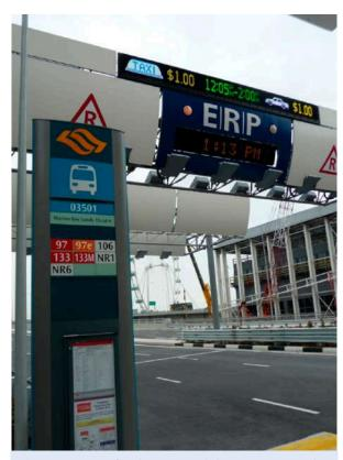
Figura 56: Las tarifas electrónicas de las carreteras ayudan a controlar el acceso de vehículos al centro de la ciudad de Singapur. Los ingresos generados se destinan parcialmente a la explotación del transporte público. © Manfred Breithaupt 2010
